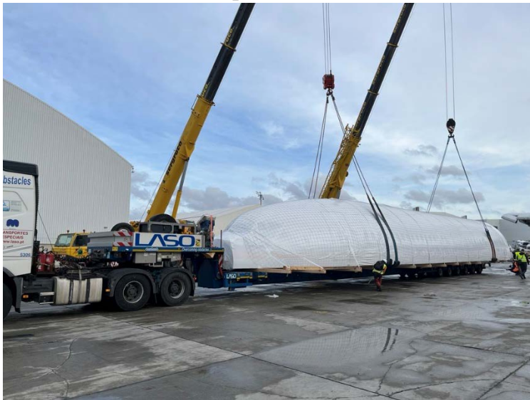
Verpacktes Rumpfteil, fertig für den Transport zum Hafen nach Castellón Foto: ITO-Logistics
